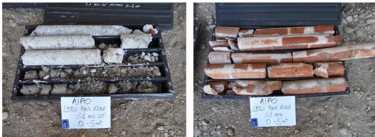
Fig. 11: Carote di materiale estratte durante i sondaggi
